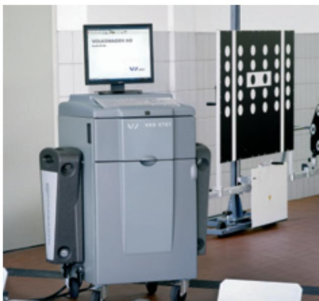
Der leicht mobile Fahrwagen mit integriertem Rechner, Drucker, 19" Monitor und Tastatur sichert auch die beiden Messwertaufnehmer.
