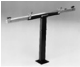
BMW-Nr. 81 33 9 429 110 Kalibriervorrichtung für die Messwertaufnehmer. Calibration device for sensors.
