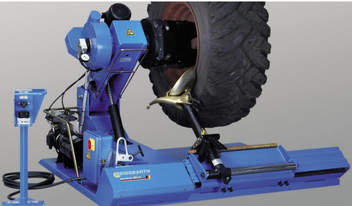
MS 75 – die 1. Wahl für LKW-, Bus- und landwirtschaftliche Nutzfahrzeug-Räder bis 910 mm Radbreite. Der regelbare Hydraulikdruck sorgt für schonende Montage/ Demontage bei LM-Rädern. Der Fahrweg des Montageschlittens und die max. Abdrückkraft von 3,7 t ermöglichen die Arbeit an Supersingles und schweren NFZ-Rädern. Die 4 Klauen Spanneinheit ist in zwei Geschwindigkeiten und beiden Richtungen drehbar. Das alles macht die MS 75 zum Universalmontiergerät für Ihren Betrieb.
